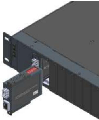
2. MCT シリーズメディアコンバータを MCT-RACK-18 のスロットに挿入し、スライダーのネジ穴と MCT-RACK-18 のネジ穴を重ね合わせて、1. で外したネジで固定してください。
