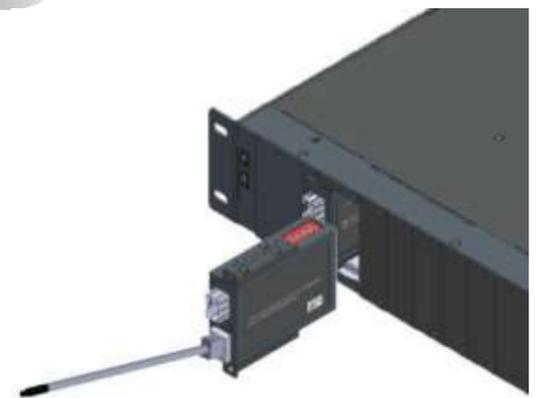
MCT シリーズメディアコンバータを MCT-RACK-18 から取り外す際は、スライダーを固定しているネジを外し、抜き取り治具を MCT シリーズメディアコンバータの TP ポートに挿入して、引き抜いてください。
