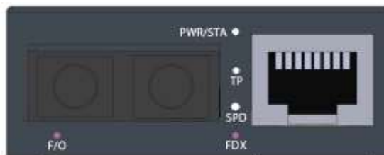
図 1. 2心ファイバタイプの前面パネル
