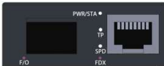
図 2. WDM及びSFPタイプの前面パネル
