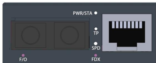
図 1. 2芯ファイバタイプの前面パネル
