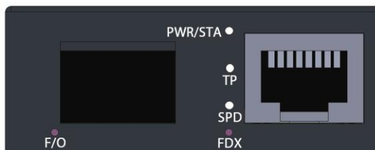
図 2. WDM及びSFPタイプの前面パネル
