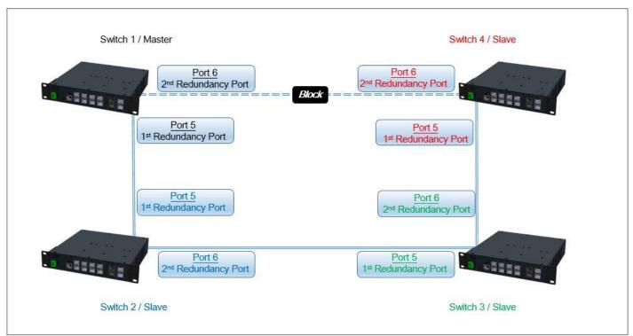
Fig. 4-1 Fast Ring v2 Example Diagram
