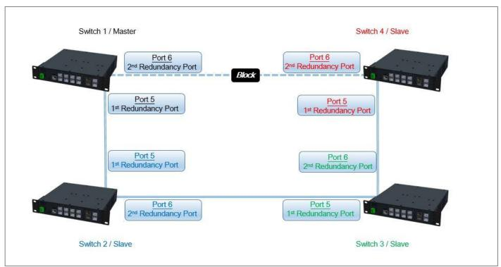
Fig. 4-1 Fast Ring v2 Example Diagram
